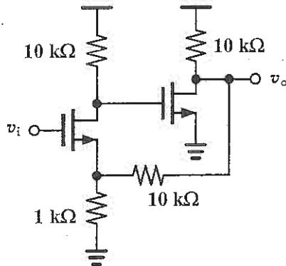
20. 如下圖所示之電路，假設電晶體皆工作在飽和區，忽略通道調變效應與基底效應，電晶體之轉導值  $g_m = 10 \text{ mA/V}$ 。請問該電路的輸出阻抗  $R_{out}$  為多少？（取小數點以下二位）
